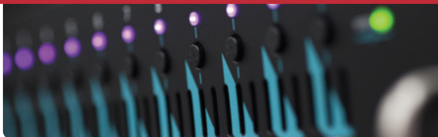
Les LEDs indicatrices permettent de visualiser le mode de chaque circuit et les défauts éventuels.
