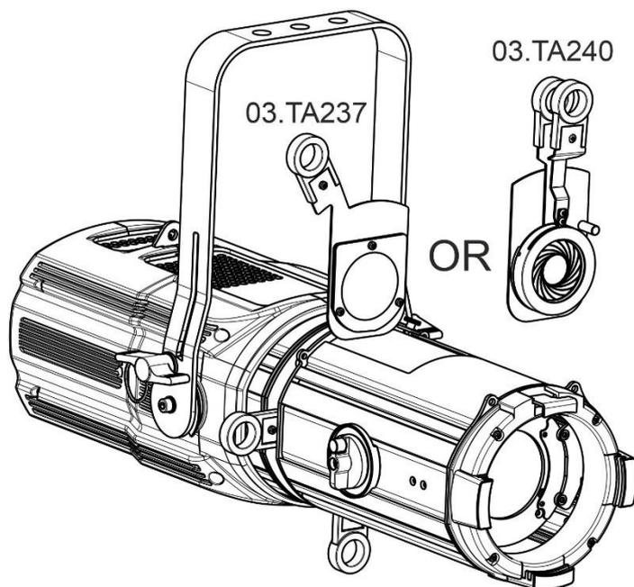
IN ORDER TO FIX , SLIDE BACK THE KNOB IN TO THE ORIGINAL POSITION AND LOCK
