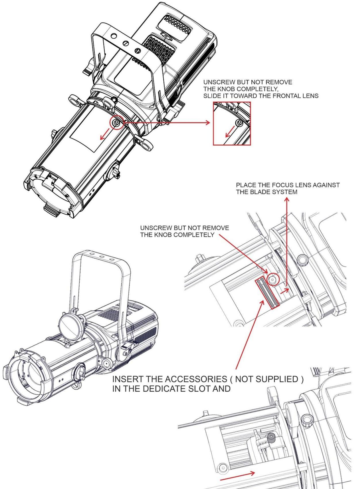
IN ORDER TO FIX , SLIDE BACK THE KNOB IN TO THE ORIGINAL POSITION AND LOCK
