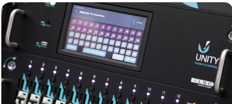
L'UCM (module de contrôle UNITY) dispose d'un écran tactile couleur 18 cm et d'un logiciel offrant de nombreuses options d'installations pour la configuration du rack UNITY. En cas de panne, le rack UNITY continuera à fonctionner indépendamment via le DMX sans que l'UCM soit connecté.
