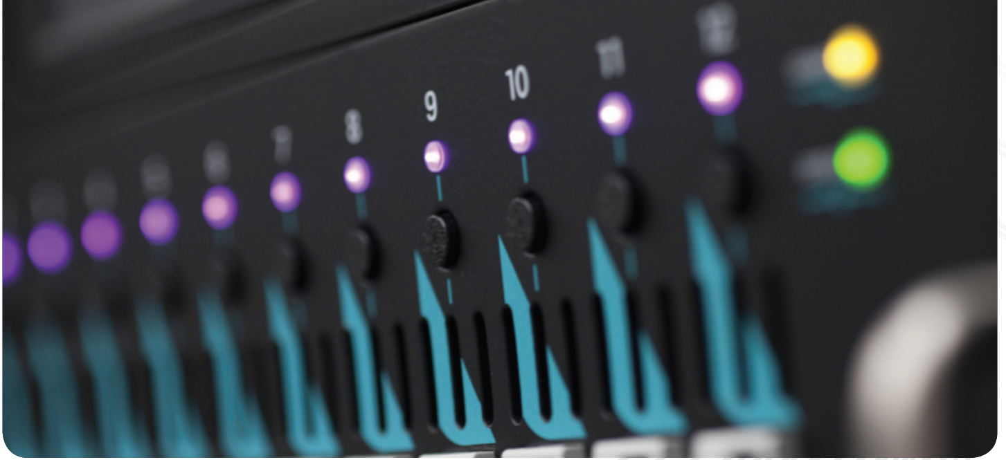
Les LEDs indicatrices permettent de visualiser le mode de chaque circuit et les défauts éventuels.
