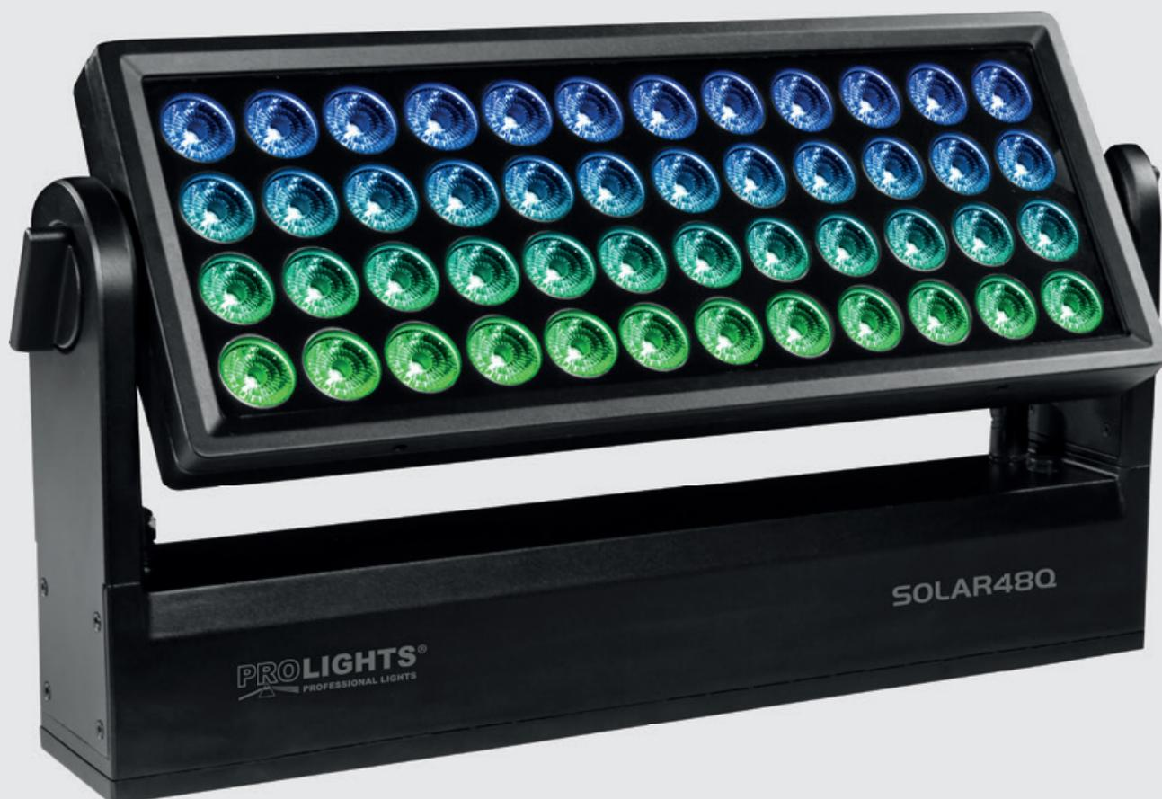
Le Solar 48Q est un projecteur wash au design très fin, puissant et polyvalent. Il est équipé de 48 LEDs Full RGBW de 10 W. Il dispose de filtres holographiques aimantés (inclus et optionnels) permettant de modifier son angle de dispersion. Il est DMX RDM et intègre un module W-DMX pour un contrôle sans fil.
