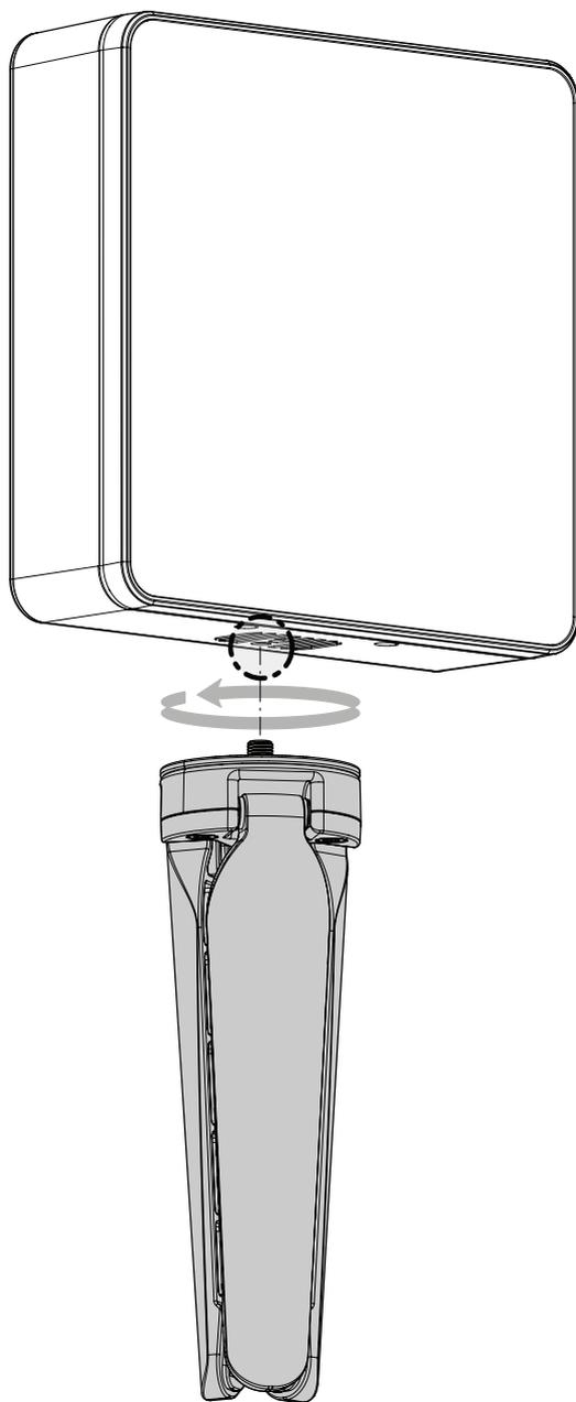
Vissez le filetage M5 marqué sur le trépied accessoire avec le trou M5 sur l'appareil.
