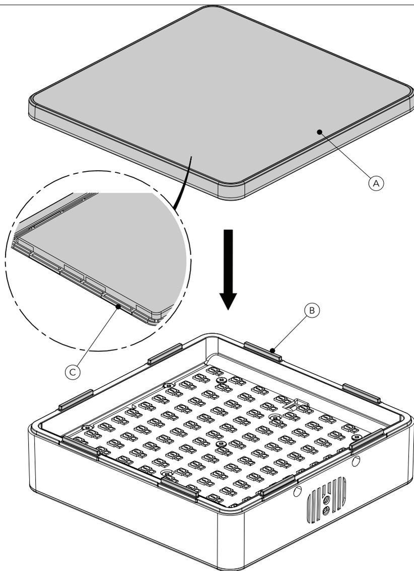
Le filtre de diffusion avant (A) est monté magnétiquement. Il suffit de le rapprocher du corps du projecteur. L'assemblage est autorisé à travers les aimants sur le boîtier (B) et les inserts équipés sur l'accessoire de cadre de filtre de diffusion avant (C).
