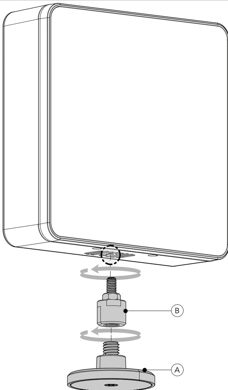
Vissez le filetage M10 sur l'accessoire ENPTWCMAG (A) avec le trou M10 sur la base de l'accessoire ENPTWCMAGDP (B).
