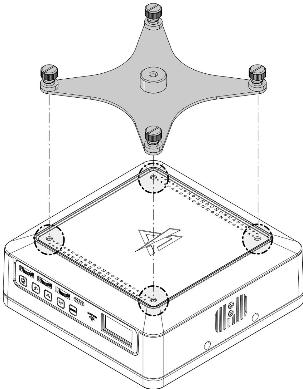
Montez quatre filetages M4 de la plaque métallique arrière marquée avec les trous M4 du boîtier arrière de l'appareil.
