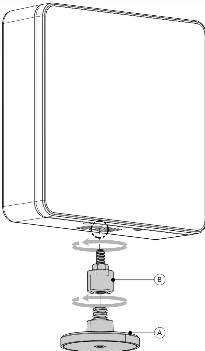
Vissez le filetage M10 sur le système de fixation d'accessoire avec aimant (A) avec le trou M10 sur la base de l'adaptateur de broche d'accessoire (B).
