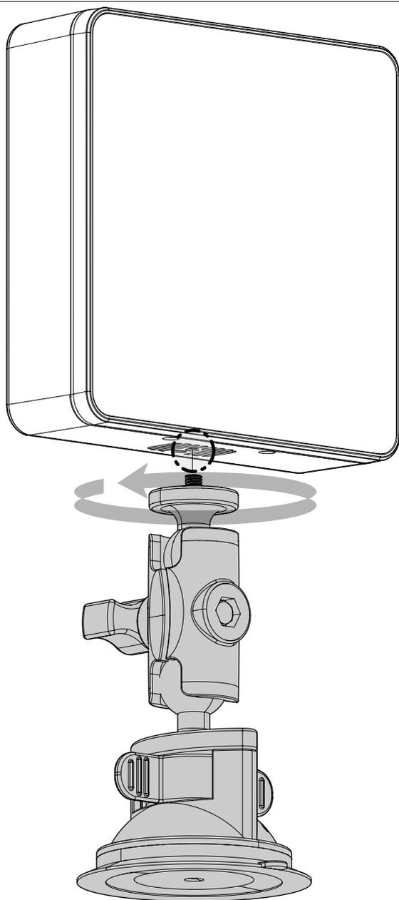
Vissez le filetage M5 marqué du système de fixation accessoire avec le trou 1/4" sur l'unité.
