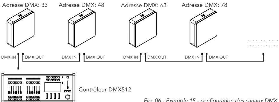
Fig. 06 - Exemple 15 - configuration des canaux DMX
